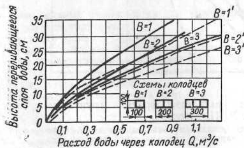
Рис. 46. График для расчета водосборных колодцев (работа колодцев трехсторонняя; нерабочая сторона колодца — длинная; при работе по четырем сторонам пользоваться пунктирными кривыми)
